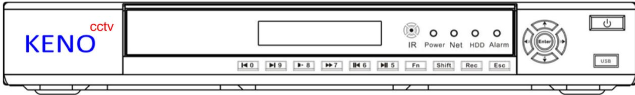
Этот цифровой видеорегистратор является качественным продуктом, предназначенным для цифрового видеонаблюдения. Он позволяет осуществлять запись видео на жёсткий диск с компрессией H.264, передачу данных по протоколу TCP/IP, а его программное обеспечение работает на ядре Linux. Продукт был разработан с применением последних промышленных технологий в ИТ. Поэтому он позволяет получить более качественное, стабильное и надёжное изображение.
